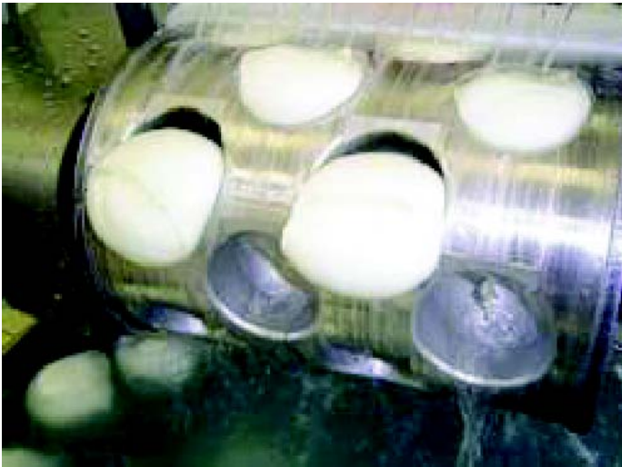
Figura 3.4.3: Formatura meccanica della pasta.
