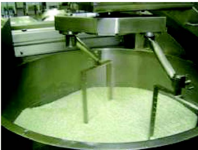
Figura 3.4.1: Rottura meccanica della cagliata
